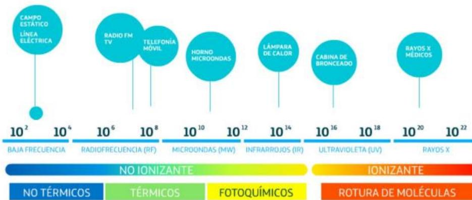
Figura 1: Clasificación de emisiones radioeléctricas
