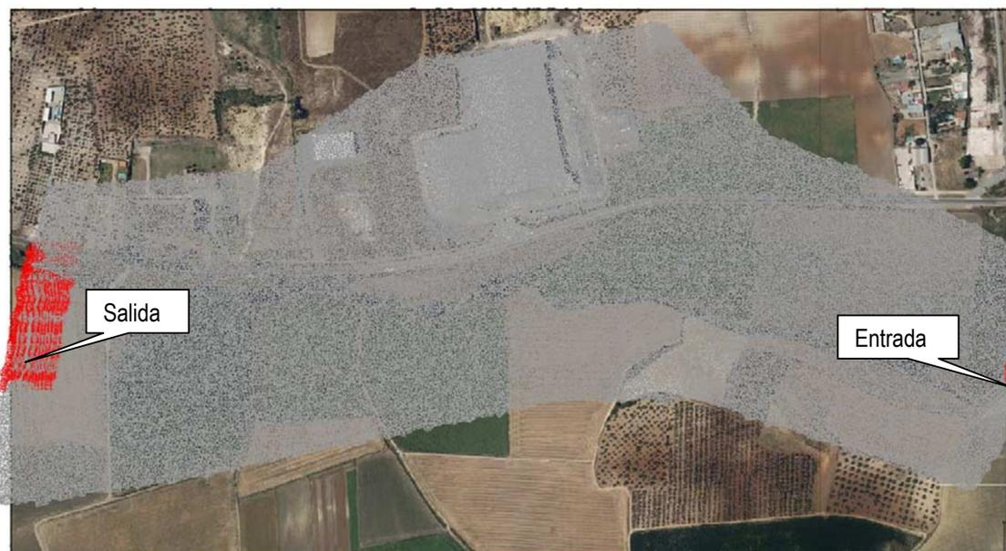
Figura Nº 6: Definición en el programa Iber 2.5 de las secciones de entrada y salida de los caudales en los cauces, mediante la selección de las entidades de superficie correspondientes.
