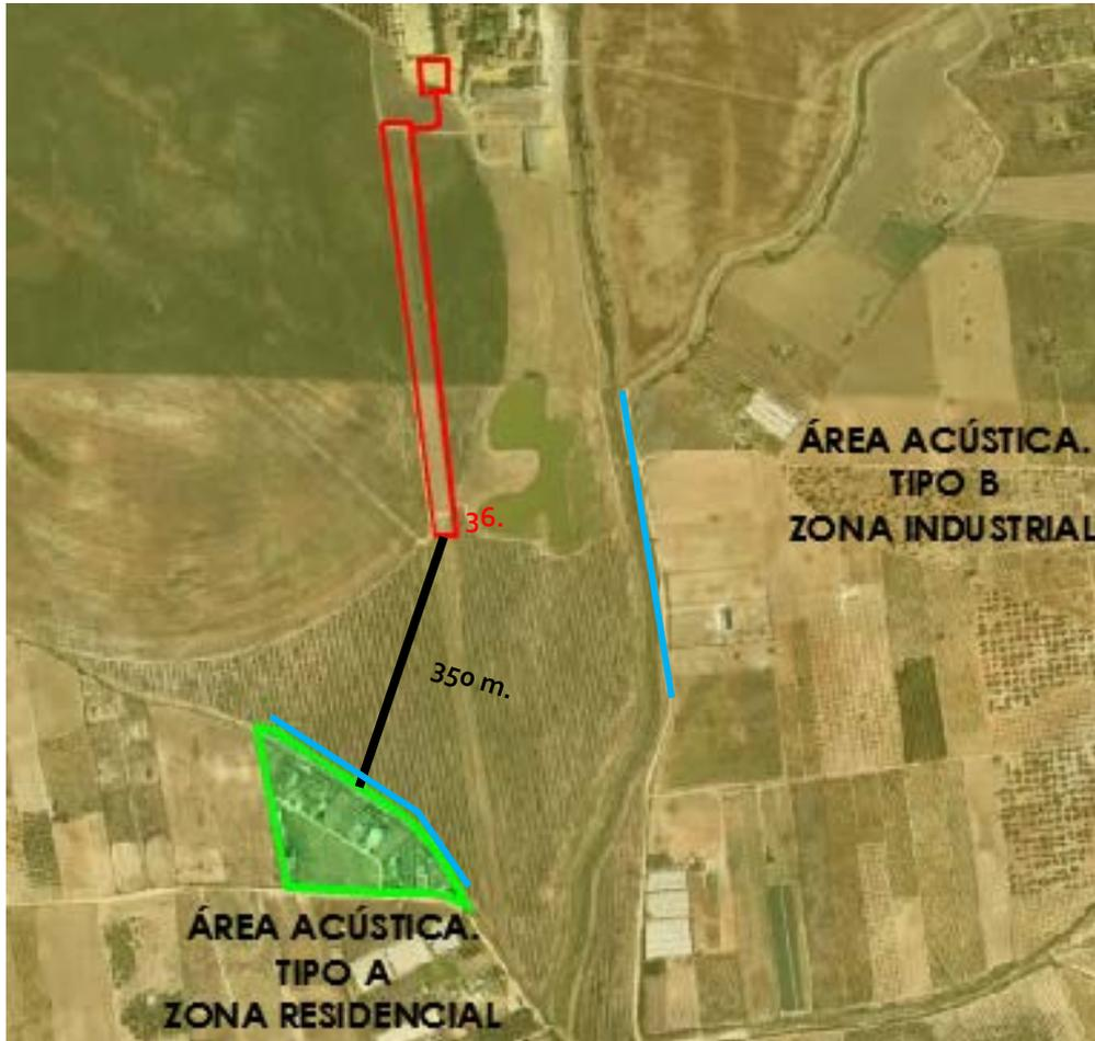
Imagen 02.- Vista ampliada de las áreas de zonificación acústica y ubicación de los focos ruidosos.
