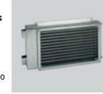
IBW Baterías de agua caliente Fabricada en chapa de acero galvanizado. Tubos de cobre. Rejas de aluminio. Con bridas rectangulares. Pueden ser montadas en posición horizontal o vertical. Máxima presión del agua: 16 bar. Máxima temperatura del agua: 110°C (130°C a 10bar) Como accesorio: Caja filtrante y interruptor de presión para reducir y controlar la suciedad de la batería.
