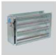
IBW Baterías de agua caliente Fabricada en chapa de acero galvanizado. Tubos de cobre. Rejas de aluminio. Con bridas rectangulares. Pueden ser montadas en posición horizontal o vertical. Máxima presión del agua: 16 bar. Máxima temperatura del agua: 110°C (130°C a 10bar) Como accesorio: Caja filtrante y interruptor de presión para reducir y controlar la suciedad de la batería.
